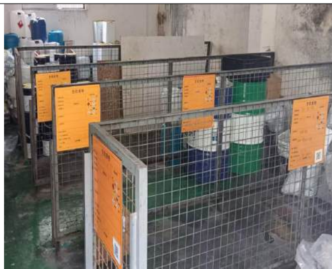
危险废弃物仓分类贮存
